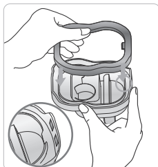
1.如图所示，将橡胶密封圈安装到槽内。
