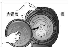
安装在锅盖时把分离式内锅盖向箭头方向对准安装槽后用力推进即可安装。
